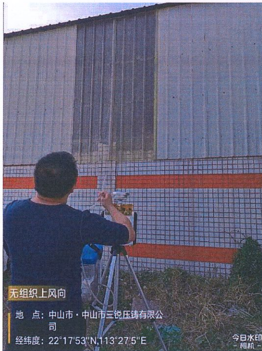
厂界无组织废气上风向参照点 1#
